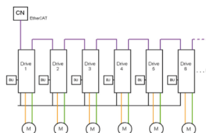
Soluzione tradizionale: un servozionamento per ciascun asse
