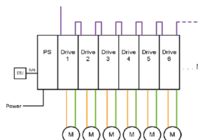
Soluzione a rack: un servozionamento per ciascun asse in una soluzione a rack
